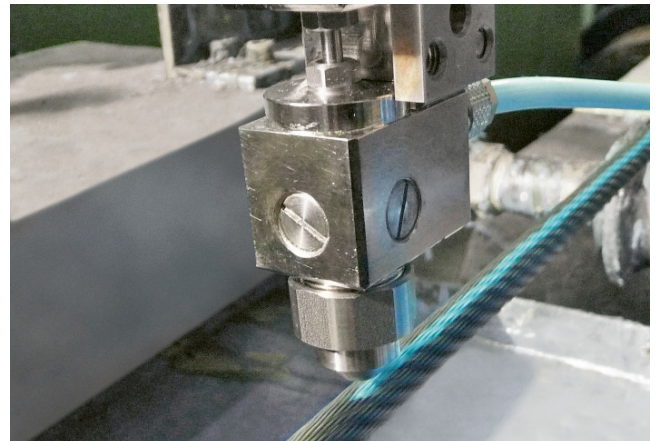
Linienmarkierung auf Stahlseilen als Montagehilfe (Drallmarkierung) für Personenlifte
