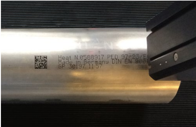
Kennzeichnung von Stahlrohren
